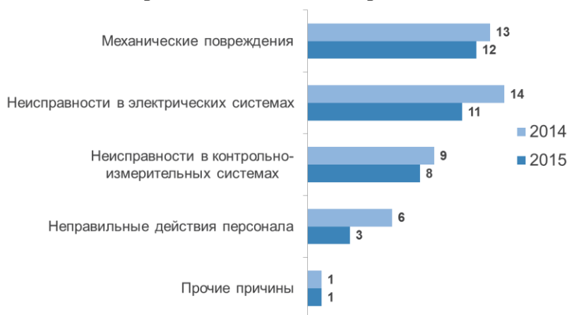
Рис. Причины отклонений в работе АЭС
